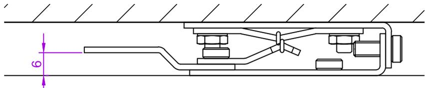
Heizelement aufgeklappt für die Montage des Anschlusskabels
